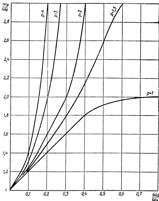
Рис. 4.15. Зависимость \frac{\omega_\beta}{\omega_\alpha} от \frac{\omega_\alpha}{\omega_n}
